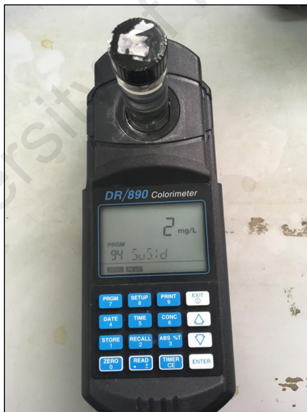
Figure 3.4.1(d) DR/890 colorimeter (HACH) to analyze TSS
