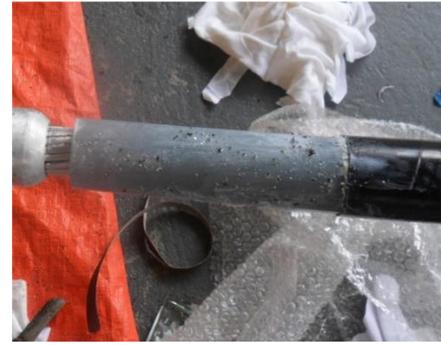
(d) Metal particle on XLPE defect
