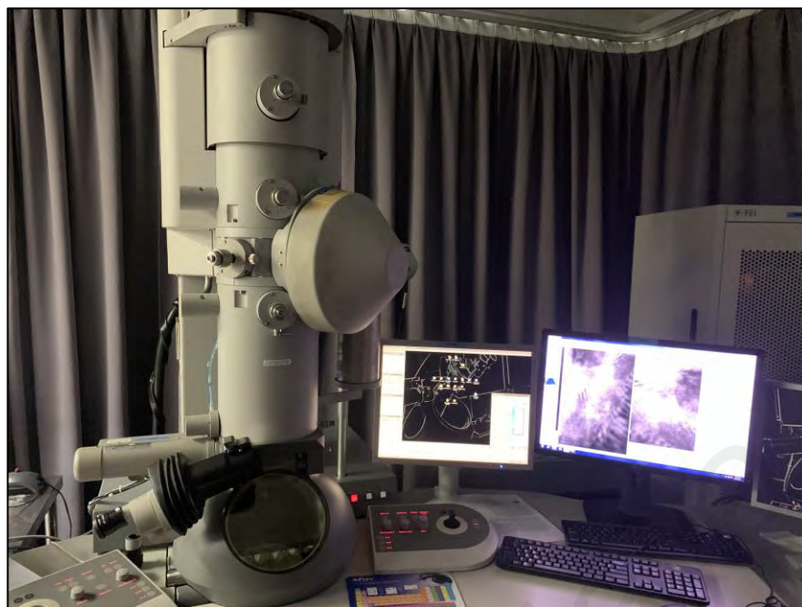
Figure 3.20: FEI Tecnai G2 F20 TEM for TEM imaging
