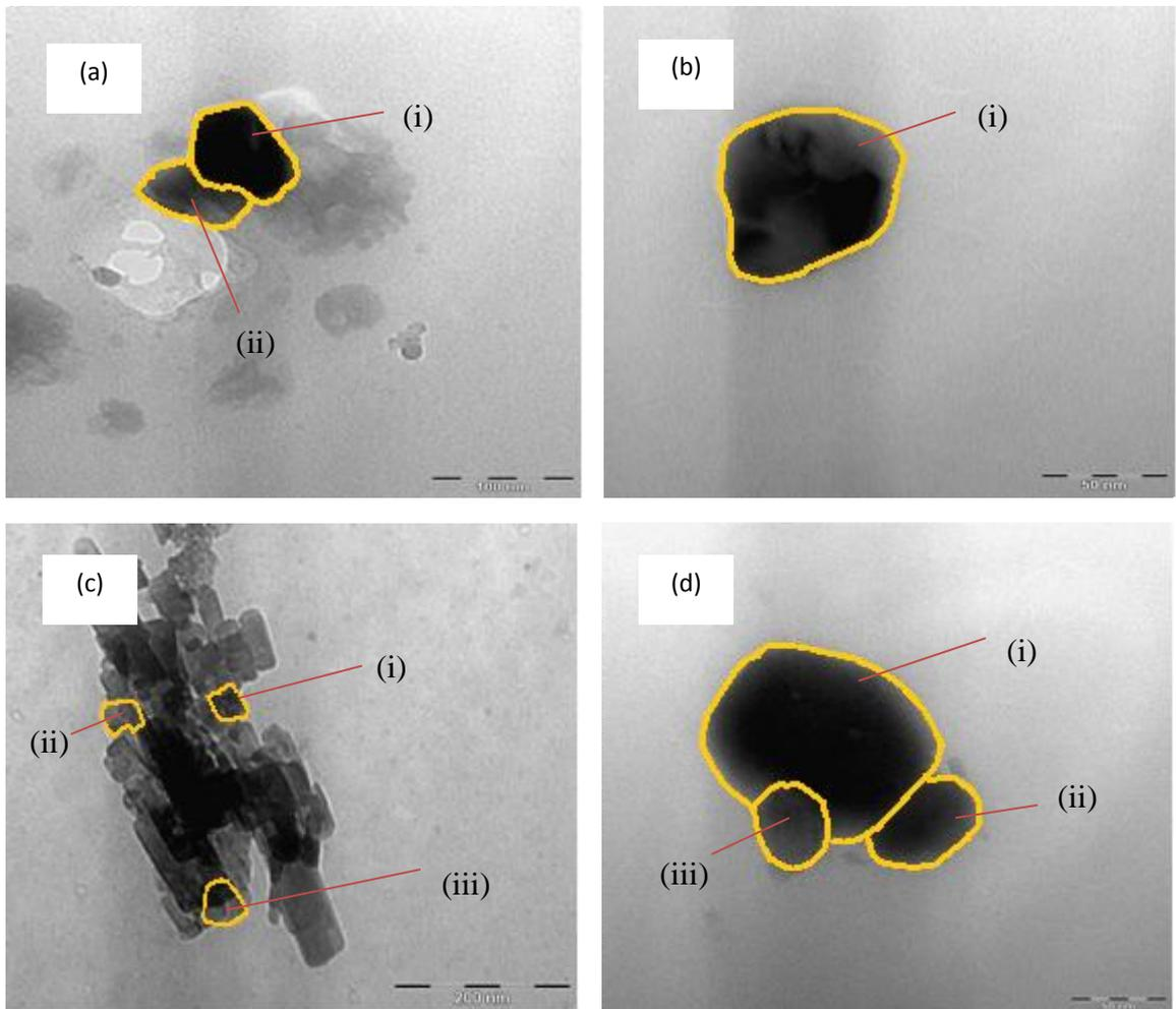
**Figure 4.5:** TEM images of  $\text{LiNiVO}_4$ - SG system at (a) 500 °C; (b) 600 °C; (c) 700 °C; (d) 800 °C
