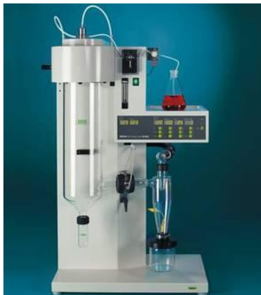
Figure 5.8: Mini Spray Dryer Büchi B-290
