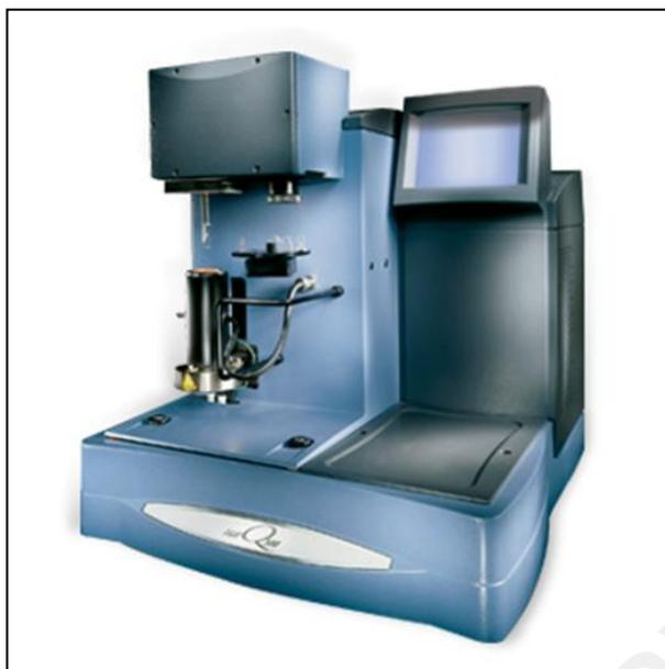
**Figure 3.11:** TGA Instrument (Q500)
