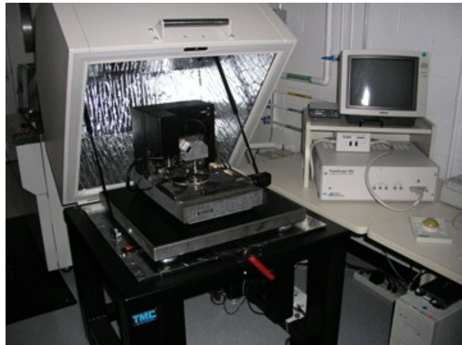
Figure 3.9 :Veeco 3000 AFM instrument.
